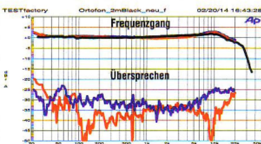
Ausgewogen mit minimaler Höhenbetonung, hervorragende Übersprechwerte
