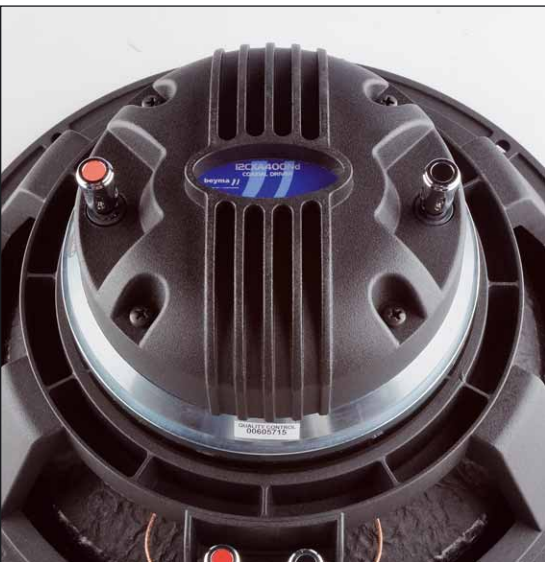
Ein mächtiger Zweizoll-Kompressionstreiber ist hinter dem Magnetsystem des Konustreibers angeflanscht
