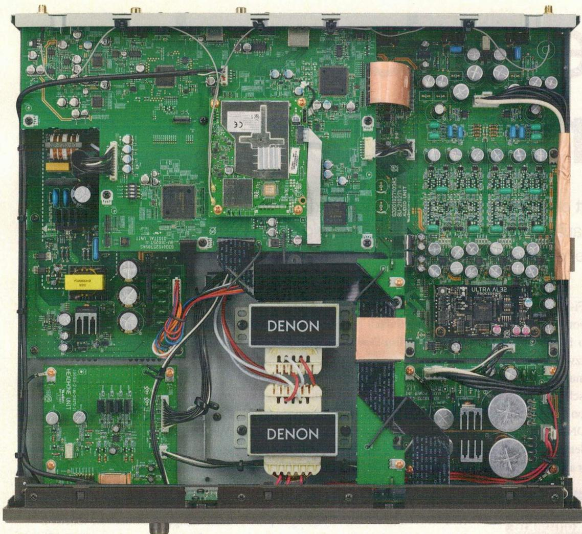
**BEACHTLICHER AUFWAND:** Das Gehäuse wird von den separat aufgebauten Elektroniksektionen und den beiden EI-Transformatoren komplett ausgefüllt. Für das Ultra AL32 Processing verwendet Denon eine eigene Platine rechts in der Mitte neben dem hinteren Transformator mit einem frei programmierbaren FPGA.
