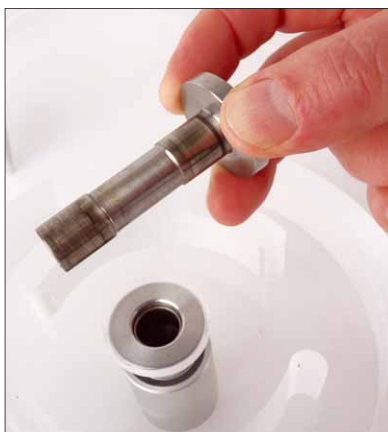
Die Achse des Tellerlagers ist in der Mitte abgedreht
