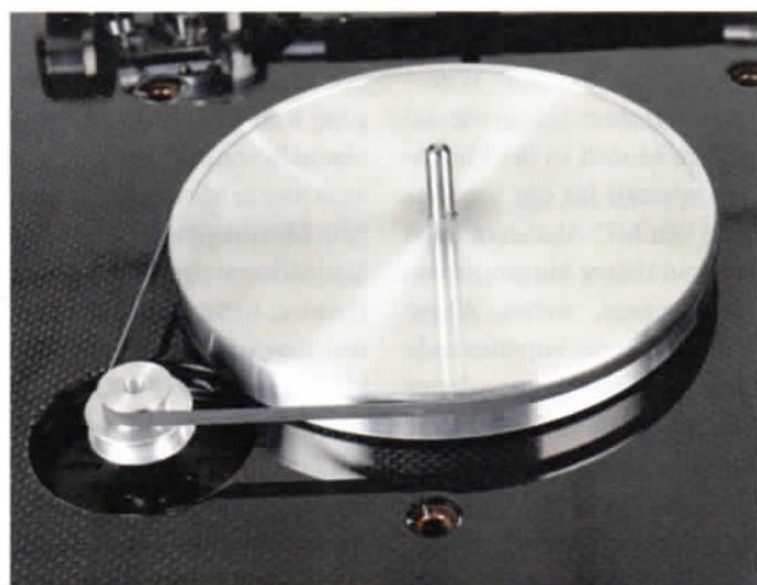
Die offenen Bohrungen sind für die Transportsicherungsschrauben. Subteller und Antriebsriemen laufen vorbildlich ruhig, der Geschwindigkeitswechsel erfolgt über das Umlegen des Riemens.
