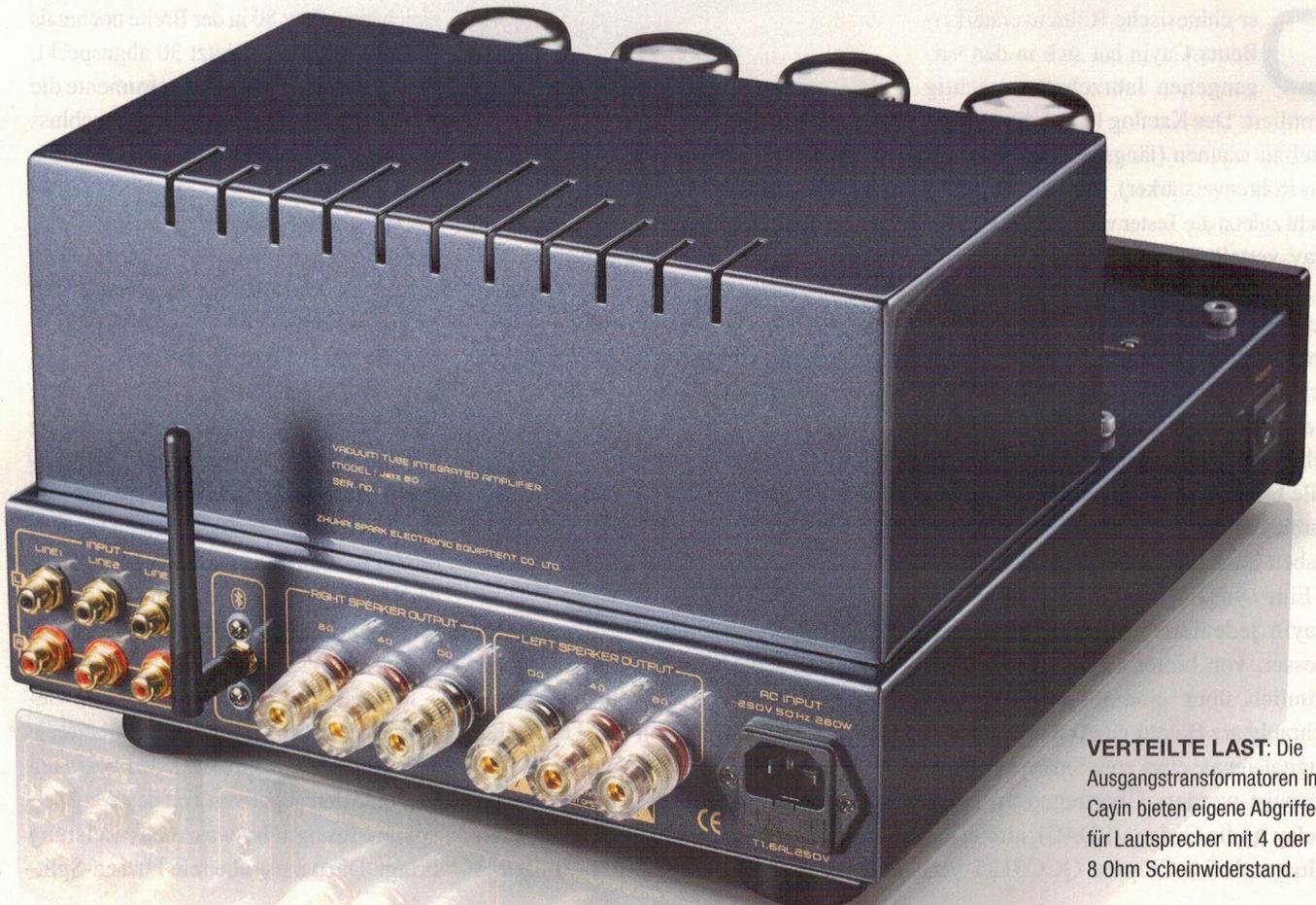
**VERTEILTE LAST:** Die Ausgangstransformatoren im Cayin bieten eigene Abgriffe für Lautsprecher mit 4 oder 8 Ohm Scheinwiderstand.
