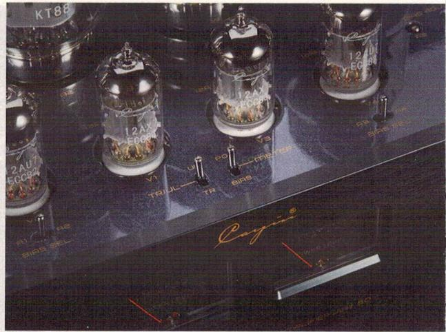
ter (im Deutschen oft irreführend Phasenschieber oder Phasenumkehrstufe genannt) das Signal in die Halbwellen aufteilen. Diesen Job übernimmt im Cayin pro Kanal eine Doppeltriode 12AU7 (ECC82). Alle Röhren auf dem Deck des Jazz 80 sind mit „Cayin“ gelabelt, die Leistungsröhren zudem mit dem Kalender-spruch „Never be the same again“. Zusammengeführt werden die Halbwellen
