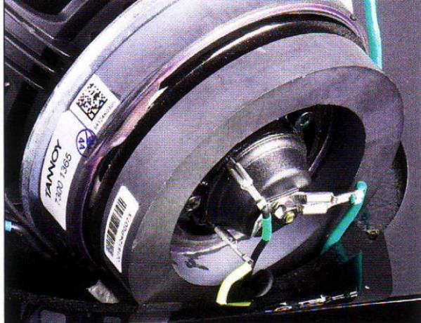
Der Druckkammertöner strahlt von hinten durch die Polkernbohrung des Tiefmitteltöners. Die Hornform mit „Tulip“-Schallführung sorgt für einen resonanzarmen und glatten Übergang zur Konusmembran.
