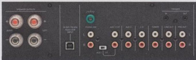
Über den Line-Out gibt der Verstärker ein fixes Signal aus – etwa für Kopfhörerverstärker –, über Pre-Out eins, das sich in der Lautstärke regeln lässt – etwa für Endstufen. Vorsicht: Steht der AUX1/HT-Schalter auf „HT“ (Home Theatre), gibt der Amp ein Signal mit vollem Pegel aus.
