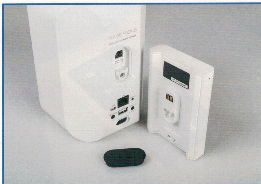
Das optionale Battery Pack wird mittels der vorgesehenen Halterung am Rücken des Pulse Flex 2i montiert und bietet bis zu sechs Stunden Akku-Laufzeit
