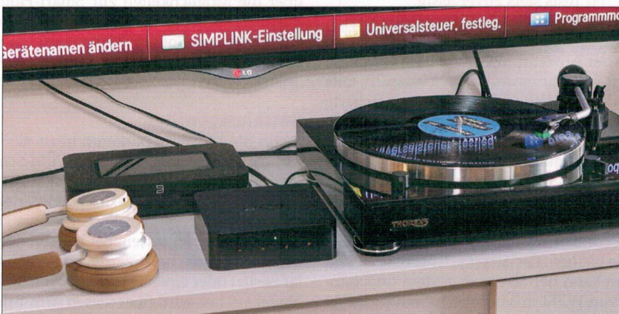
Der Pro Plus streamt Signale einer per Cinch oder optisch angeschlossenen Quelle weiter – an WiiM-Geräte oder dank Bluetooth und Airplay auch an markenfremde Empfänger.
