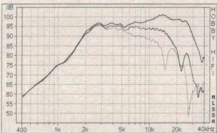
Schalldruck-Frequenzgang auf unendlicher Schallwand axial, unter 30° horizontal (---) und 30° vertikal (...) Besonders hoher Wirkungsgrad: schon ab 2,5 kHz über 95 dB; starke Richtwirkung im oberen Hochtonbereich
