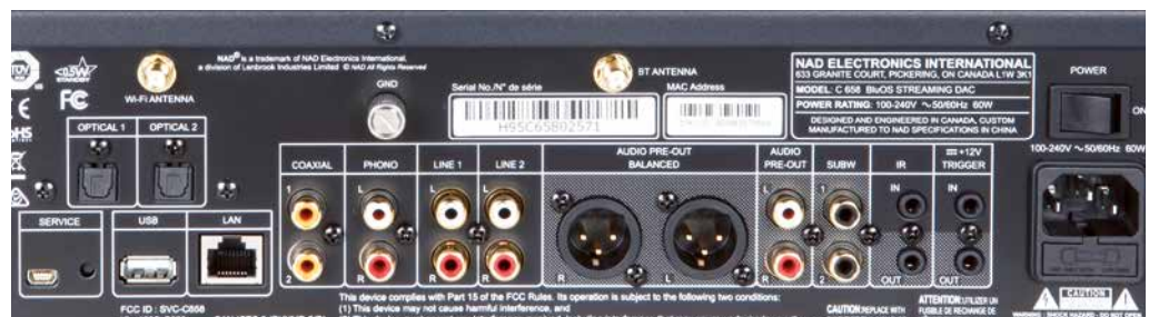
Untypisch für NAD ist das pralle Ausstattungspaket inkl. LAN, Phono und DAC-Optionen. Die Antennen für Drahtlos-Empfang sind nicht abgebildet.
