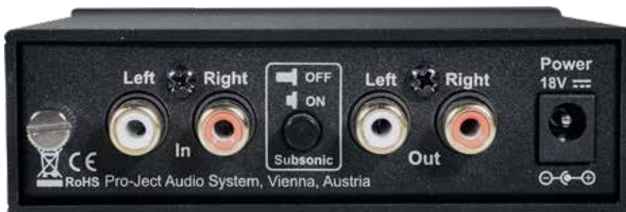
Bei der Phono Box S2 geht alles etwas gedrungener zu. Für einen Trigger-Anschluss, wie ihn die Phono Box DS2 hat, blieb hier kein Platz übrig
