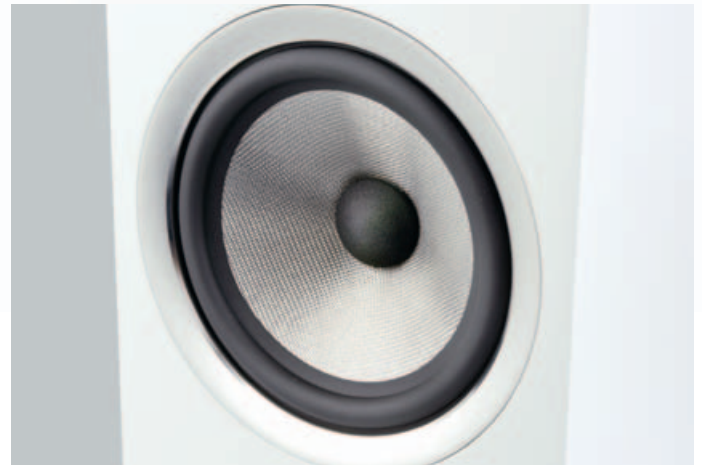
Im Gegensatz zum sickelosen Mitteltöner der Standboxen hat der Tief-/Mitteltöner der 706 eine Sicke, was ihn gleichmäßig und nicht nur innen kolbenförmig schwingen lässt.
