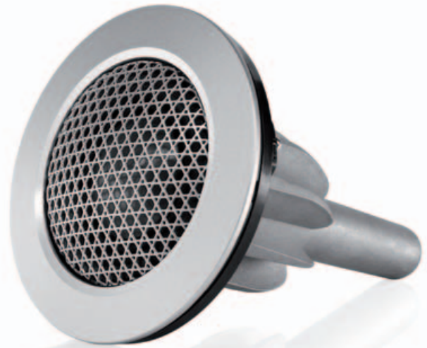
Neuentwicklung: Der Carbon-Dome-Hochtöner verfügt über eine mit Kohlenstoff beschichtete Alukalotte (daher die dunkle Färbung), die von einem 0,3 mm starken Kohlefaserring versteift wird. Sie soll der Diamantkalotte klanglich recht nahe kommen.
