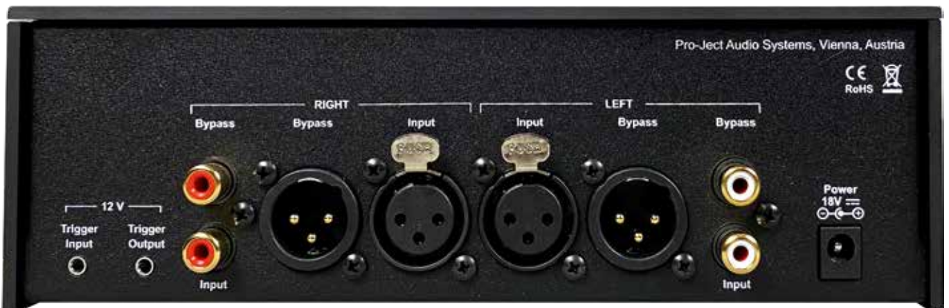
Wir hätten uns die unsymmetrischen Anschlüsse in der Mitte gewünscht und die XLRs außen. Dass man getrennte symmetrische Kabel benutzt, ist wohl doch wahrscheinlicher, als getrennte unsymmetrische Kabel. So muss man eventuell auf ein großes Y-Kabel ausweichen
