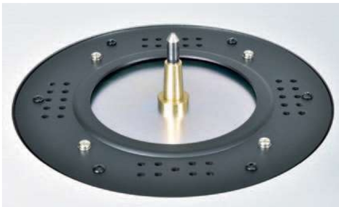
Der zentrierende Lagerkonus für den Teller: Eine alte Technik, die man heutzutage nicht mehr allzu oft sieht: Hier sind Motor und Tellerlager ein- und dasselbe, übrigens wartungsfrei.
