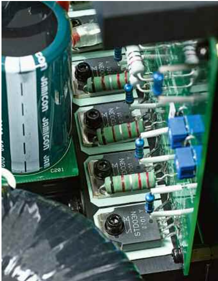
Die Leistungsträger der Endstufe stammen aus dem Transistor-Königshaus Sanken
