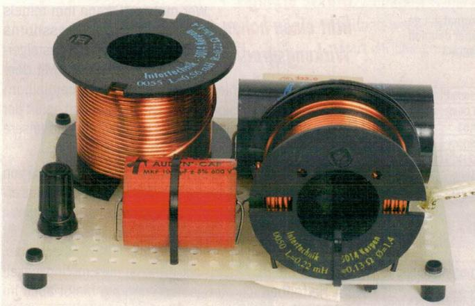
Die Achsen der beiden Spulen auf der Platine, einer LP/RA140 von Intertechnik, stehen senkrecht zueinander. Das minimiert die magnetische Kopplung. Da wir das Korrektornetzwerk außerhalb der Lautsprecher angeschlossen haben und es in Reihe mit diesen liegt, verfügt es über eine Polklemme für das Eingangssignal und ein kurzes Kabelende für den Anschluss an eine der beiden Lautsprecher-Eingangsklemmen.
