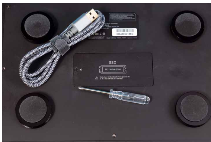
Unten im Boden gibt es ein Fach für eine SSD-Festplatte, zum Lieferumfang gehört ein passender Schraubendreher und ein USB-Anschlusskabel für den PC
