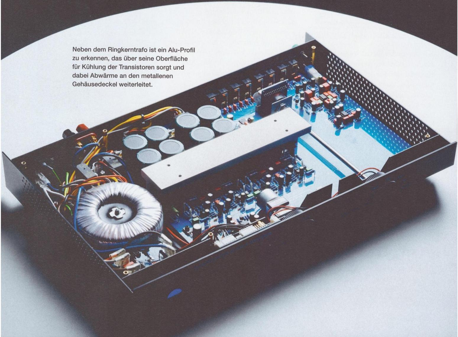
Neben dem Ringkerntrafo ist ein Alu-Profil zu erkennen, das über seine Oberfläche für Kühlung der Transistoren sorgt und dabei Abwärme an den metallenen Gehäusedeckel weiterleitet.
