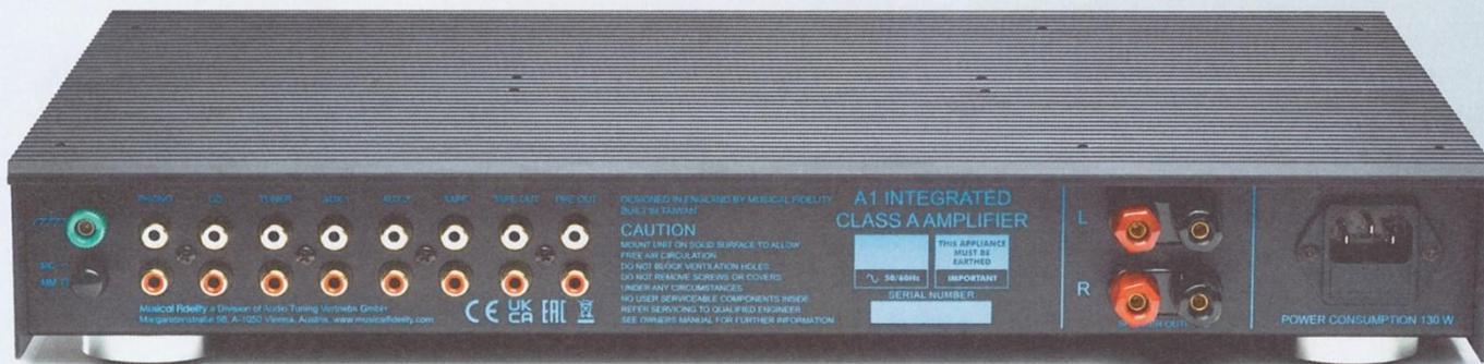
So gut wie auf diesem Foto kann man die Beschriftung der Eingänge nur ablesen, wenn man sich direkt hinter den A1 hockt. Neu ist der umschaltbare Phono-Eingang für MM und MC (ganz links). Geblieben ist dagegen der Verzicht auf Anschlüsse für ein zweites Boxenpaar.
