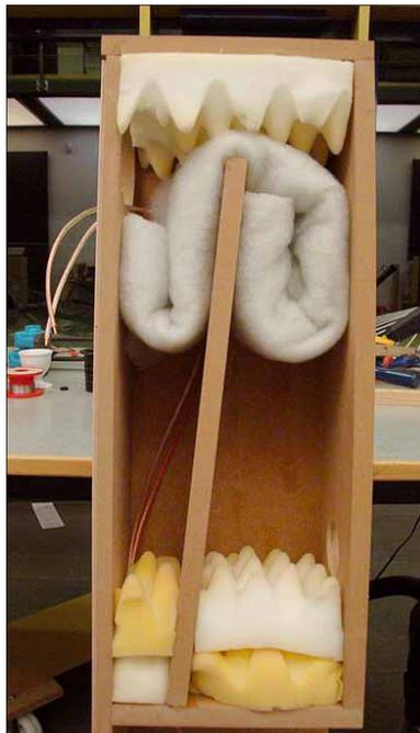
So wird die Gehäusedämmung im Gehäuse verteilt
