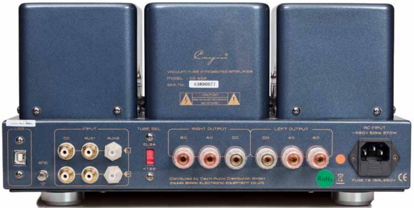
Die Lautsprecheranschlüsse sind für 4- und 8-Ohm-Modelle ausgelegt, einer der drei Cinch-Eingänge kann wahlweise gegen einen Phono-Anschluss ausgetauscht werden. Links außen sitzt ein USB-Port, der Digitalsignale vom Computer mit bis zu 32 Bit und 384 Kilohertz aufnimmt
