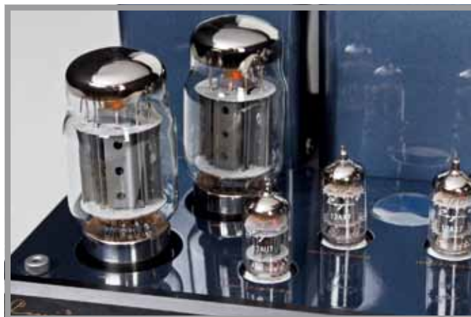
In der Vorstufe des Cayin CS-55A arbeiten jeweils zwei Röhren vom Typ 12AX7/ECC83 und zwei 12AU7/ECC82. Die Endstufe wird wahlweise von vier KT88 oder EL34 versorgt
