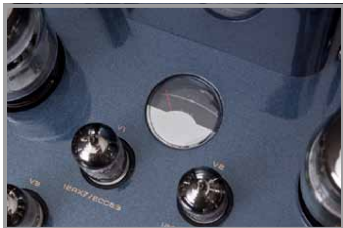
Maximale Flexibilität: Ein mittig patziertes Anzeigeninstrument und zwei leicht zugängliche Schalter, helfen beim Bias-Feinabgleich der vier Endstufenröhren
