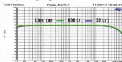
Ausgewogener Frequenzgang mit hoher Laststabilität
