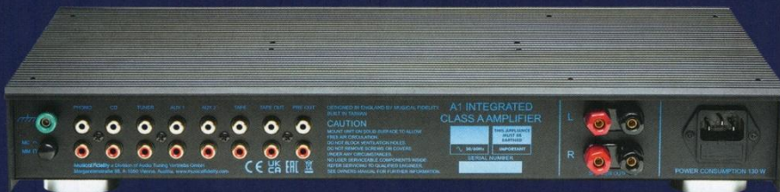
Die Auswahl an analogen Anschlüssen dürfte selbst für den anspruchsvollsten Anwender ausreichen. Wichtig: hier können wir auch zwischen MC- und MM-Tonabnehmern umschalten
